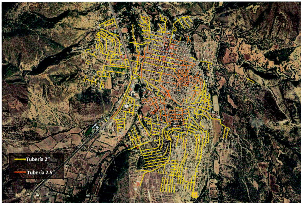
Ilustración 1.- Tuberías existentes de 2" y 2.5" de diámetro a reemplazar.
