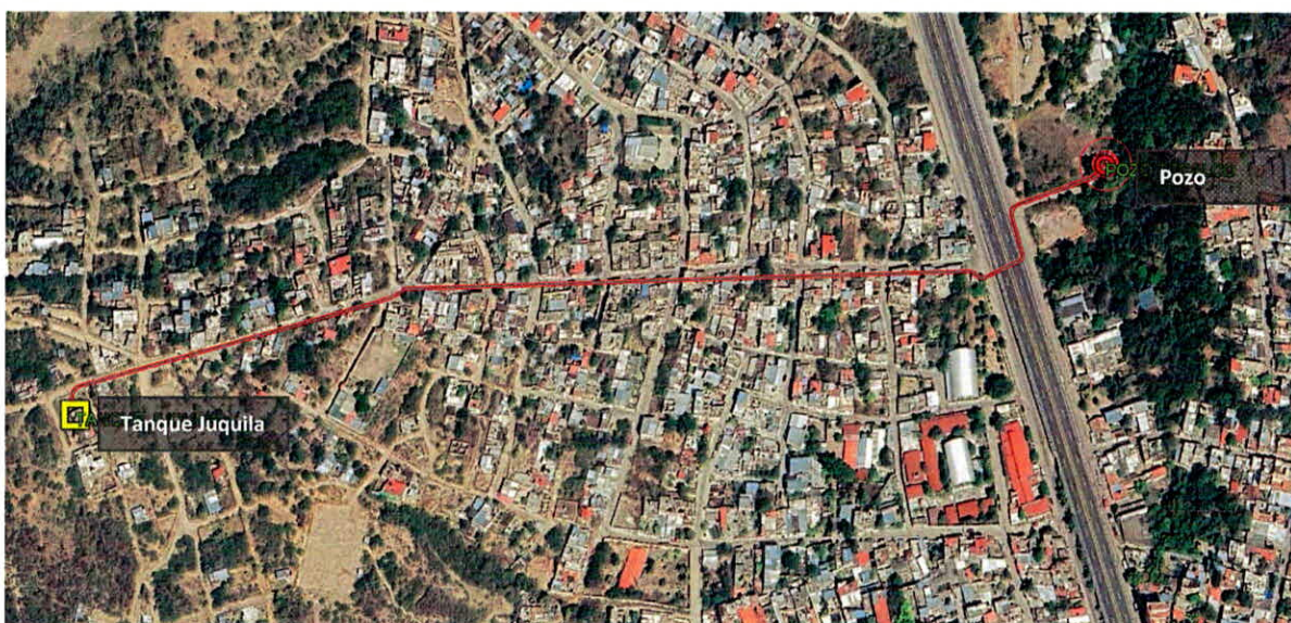
Ilustración 3.- Línea de bombeo pozo Tecalco a Tanque Juquila
